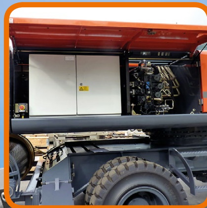
Schaltkasten für E-Antrieb
