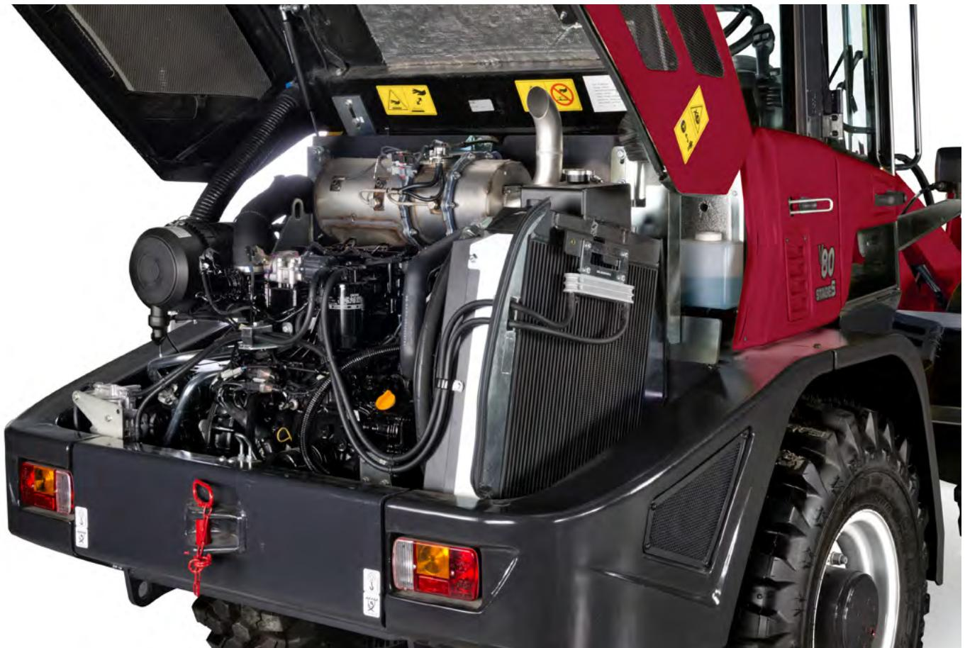
Für eine schnelle und einfache Wartung des Gerätes ermöglicht die große Öffnung der Motorhaube einen einfachen Zugang zu allen wichtigen Wartungselementen. Dies trägt zur Reduzierung der Gesamtbetriebskosten (TCO) der Maschine bei.
