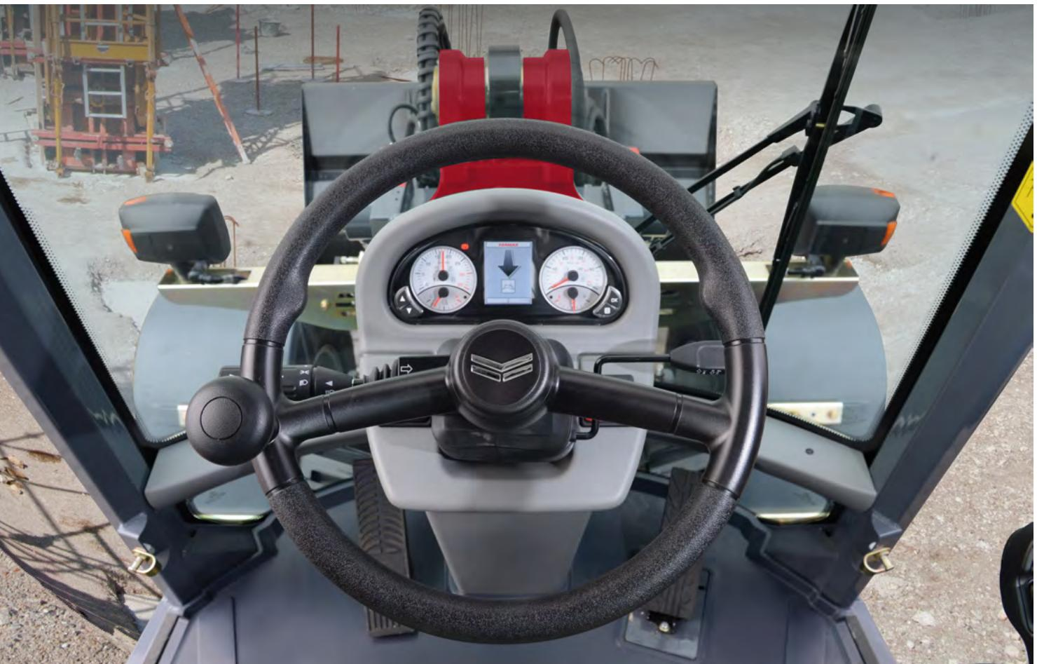
Die für Bedienerkomfort und Produktivität konzipierten Kabinen verfügen über Geräusch- und Vibrationsdämpfung sowie ROPS- und optionaler FOPS-Zulassungen.
