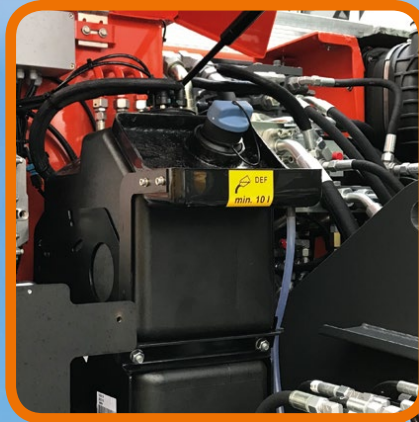
Leicht zugänglicher AdBlue®-Tank
