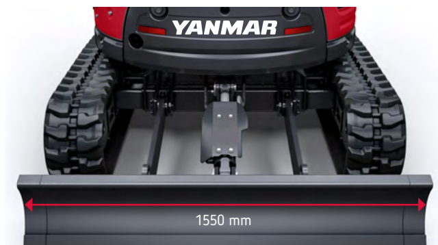
Ausgefahren: mehr stabilität für verbesserte grab - und ladeleistung
