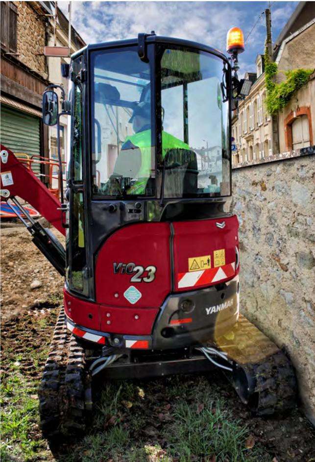
Der Vi023-6 ist ein Nullheck-Minibagger, der in den engsten Stellen arbeitet. Dieses Konzept sorgt für kühlen Kopf des Yanmar Kunden, gerade auf sehr beengten Baustellen.
