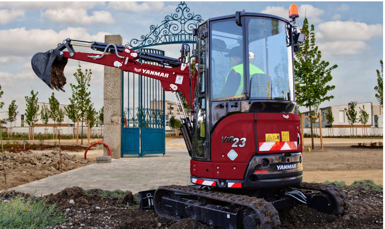
Der ViO23-6 beeindruckt mit außergewöhnlicher Leistung für eine Maschine dieser Klasse. Seine Grabtiefe von 2450/2655 mm\* und Grabkräfte von 17,5 kN (Löffel) und 13,1 kN / 10,6 kN\* erlauben selbst unter den härtesten Bedingungen schnelles und effizientes Arbeiten.
