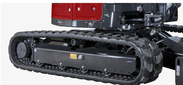
Die X-förmige Hohlkastenkonstruktion des Unterwagens weist eine exzellente Verwindungssteifigkeit auf. Der Rahmen ist für maximale Haltbarkeit optimiert.
