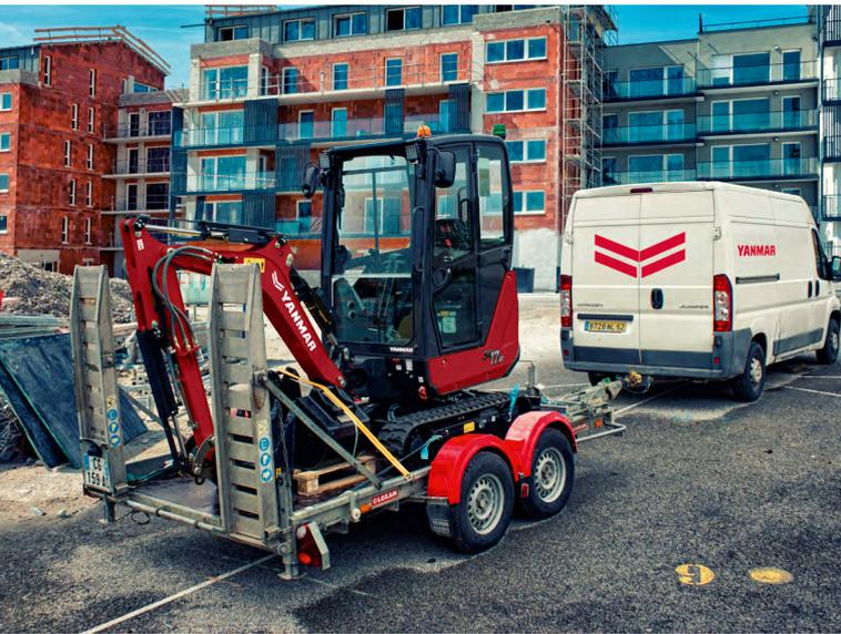
Der SV17vr liefert trotz seiner kompakten Abmessungen die Leistung und Kraft eines wesentlich größeren Modells. Der geringe Wenderadius an Front und Heck mit einer breiten Auslegerschwingungsamplitude nach links machen die Maschine zur perfekten Lösung für das Grabenziehen und Landschaftsbauarbeiten auf urbanen Flächen oder in beengten Wohnanlagen.
