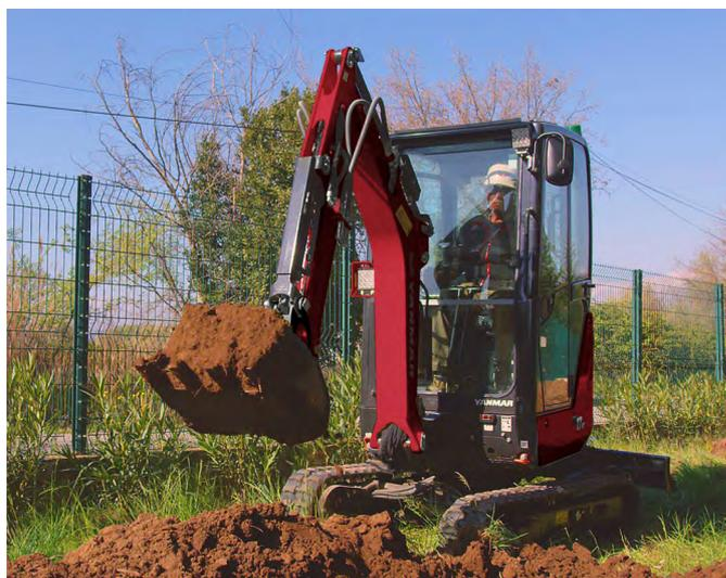
Mit seiner Grabkraft von 9,9/16 kN (kurzer Stiel/Löffel), 12,8 kN/8 kN Traktionskraft (1./2. Gang) und zwei über den Schildbedienhebel wählbaren Fahrgeschwindigkeiten (2,4 oder 4,8 km/h), liefert der SV17vr die Kraft und Leistung eines wesentlich größeren Modells.
