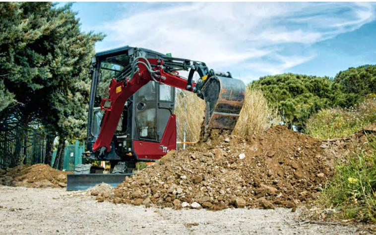
Leistungsstark, verlässlich und hart im Nehmen wurde der SV17vr so konzipiert, dass er selbst unter den härtesten Bedingungen Großes leistet. Standardmäßig ausgestattet mit Auslegerzylinderschutz, Hydraulikschlauchführung im Ausleger und der hohen Position des Auslegerzylinders selbst, profitieren Bediener von maximalem Schutz und minimalen Stillstandzeiten.
