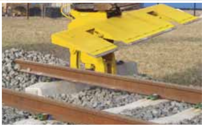
Der RBS Bahnschwellenwechsler entfernt und positioniert Bahnschwellen bei bereits angelegten Schienensystemen
