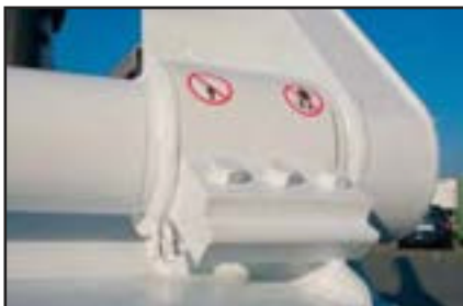
In Bronzebuchse gelagertes Hauptlager, groß dimensionierte Drehwelle.
