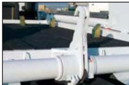
Pneumatischer Kipphebel, zwangsverriegelt.
