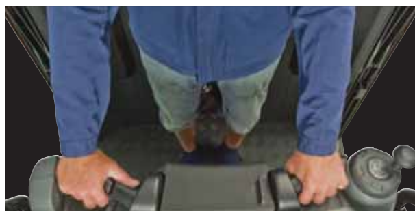
Das Mehrfach-Totmannsystem prüft, ob der Fahrer sicher in der Kabine steht, bevor das Gerät anfährt
