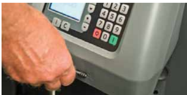
Zum Starten der BT Optio H-Serie ist ein PIN-Code oder ein ID-Transponder (optional) erforderlich
