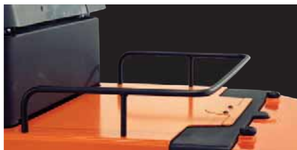
Dank des Haltebügels des OME100 und OME100W kann die Oberseite des Fahrzeugs als temporäre Ablage verwendet werden
