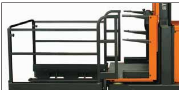
Die 'W'-Modelle der M-Serie verfügen über eine offene Hubkabine zum Kommissionieren großvolumiger Teile
