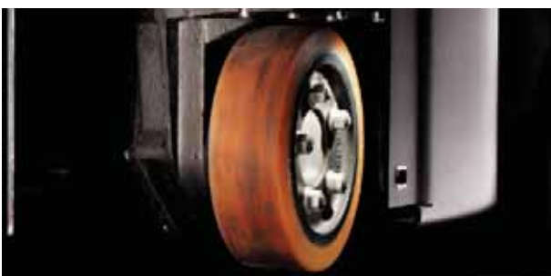
Deutlich geringerer Antriebsrad-Verschleiß durch elektronisch geregeltes Beschleunigen/Bremsen
