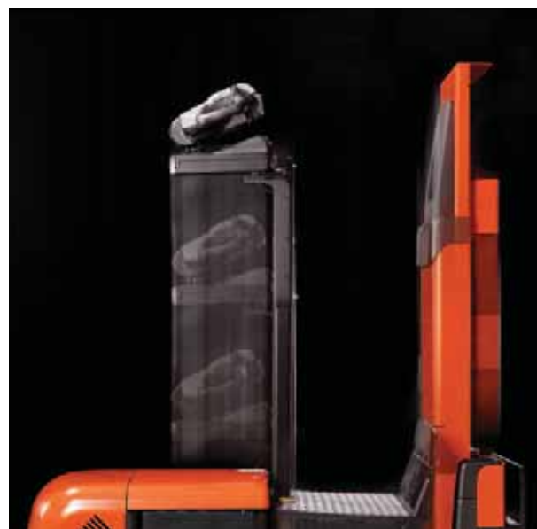
Bei Modellen mit hebbarer Fahrerplattform wird die Lenkeinheit mit angehoben – zum Fahren und Positionieren des Gerätes mit angehobener Plattform
